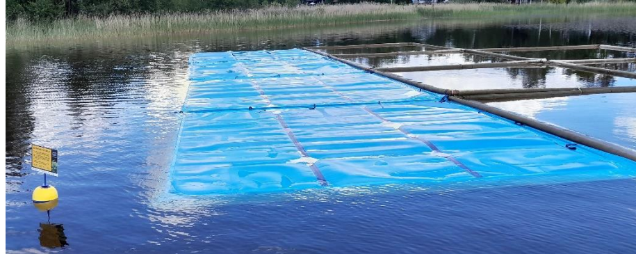
Prototyperna för nya flytande dukar testas i Mälaren.
