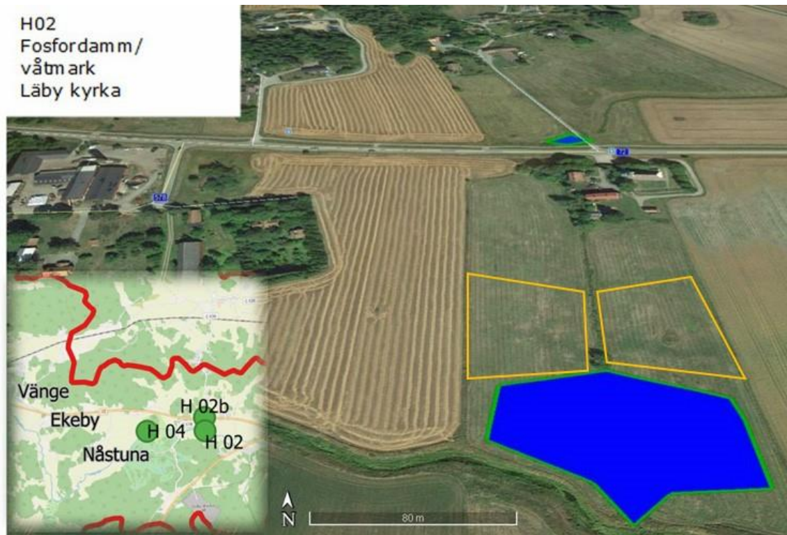
Figur 2. Illustration av föreslagen fosfordamm och våtmark vid Läby kyrka. Lämplig mark för upplag av schaktmassor i orange. Flygfoto: Google Earth Bakgrundskarta: openstreetmap.org
