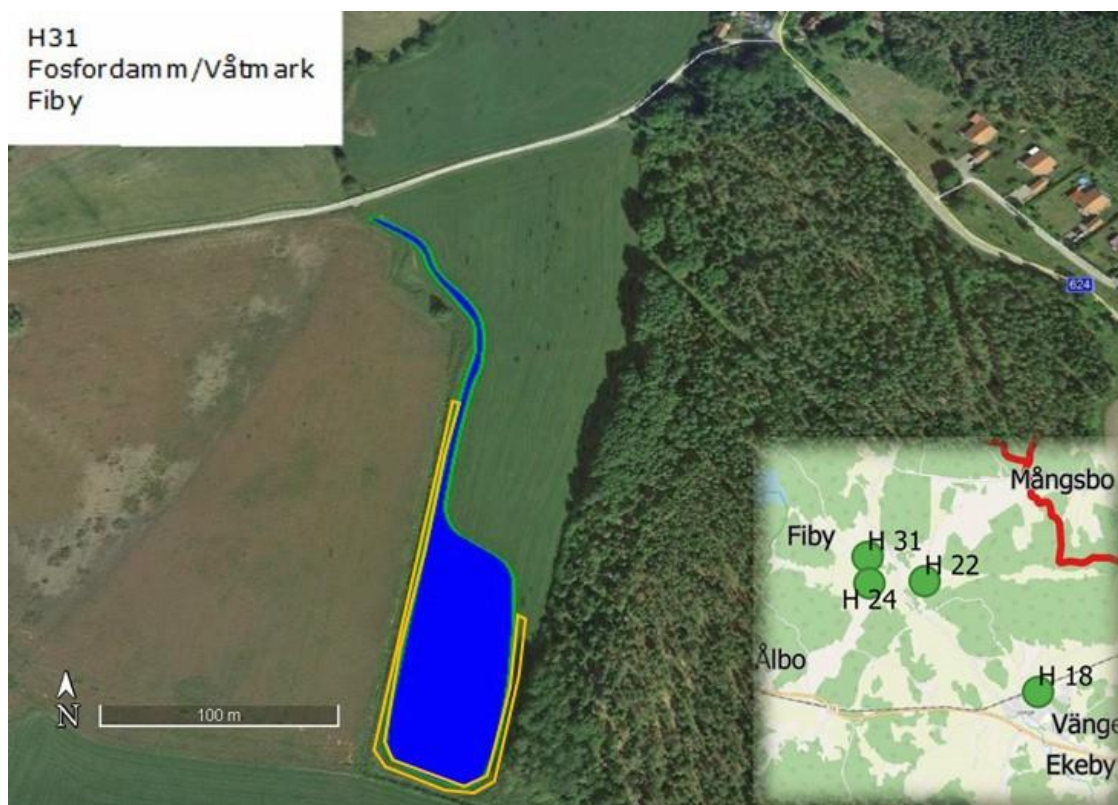
Figur 6. Illustration av föreslagen fosfordamm/våtmark vid Fiby (H31). I orange syns platsförslag för en vall som görs av schaktmassorna. Flygfoto: Google Earth Bakgrundskarta: openstreetmap.org
