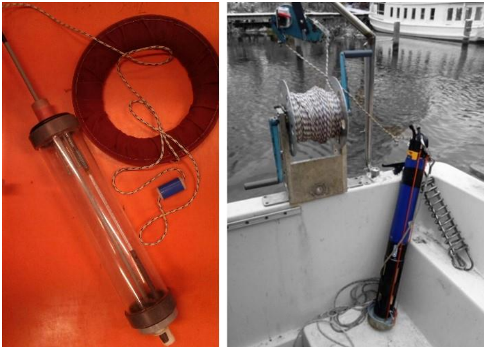
Figur 18. Till vänster i syns en Ruttnerhämtare som används vid provtagning av vattenprover i sjöar. Den blå multisonoden i den högra bilden användes vid utvärderingen. Foto: Stina Drakare & Stephan Köhler, SLU.
