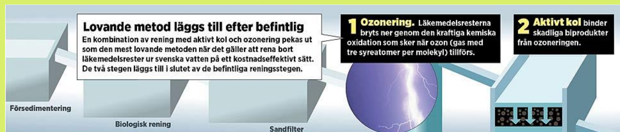
Figur 19. Extra reningssteg (ozonering och aktivt kol) testas inom forskningsprojektet Mistrapharma för att bättre kunna rena avloppsvatten från läkemedelssubstanser. Bild från www.nyteknik.se .
