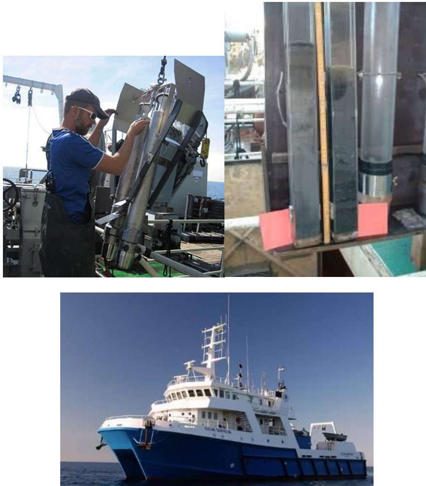
Bild 15. (vänster): "Sedimentprovtagare" av Marinen, SGU. (höger): "Sedimentkärna provtagen med Geminilod" av Marinen, SGU. (under): "SGU:s undersökningsfartyg Ocean Surveyor" av Björn Bergman, SGU. (© Sveriges geologiska undersökning).
