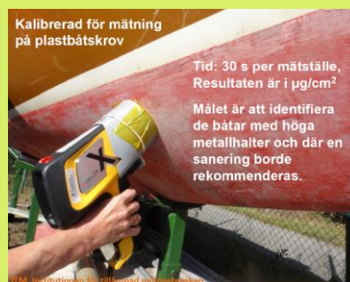
Bild 3: XRF-scannern använder fluorescenssteknologi för att snabbt kunna mäta metallhalter i båtbottnfärger. (Foto: ITM 2014).
