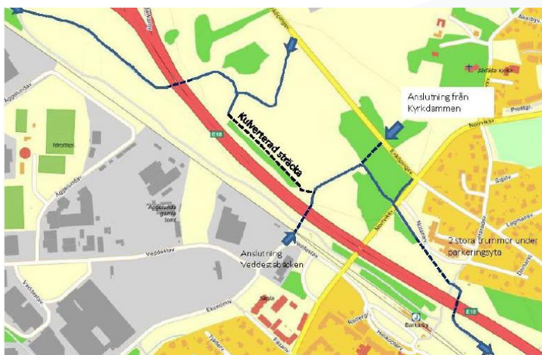
Figur 16. Befintligt vattensystem med öppen vattenfärd och kulvertering (streckad linje). Källa: Barkarbystaden II, Vatten och dagvattenutredning 2014-06-03.
